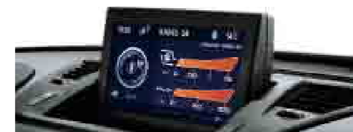
Op het Instant Nav-display wordt ook de turbodruk weergegeven, evenals het geleverde vermogenspercentage.
