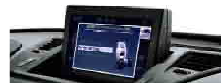
Alfa Romeo D.N.A. communiceert met het Instant Nav-systeem: de geselecteerde rijmodus wordt duidelijk getoond op het pop-up display.
