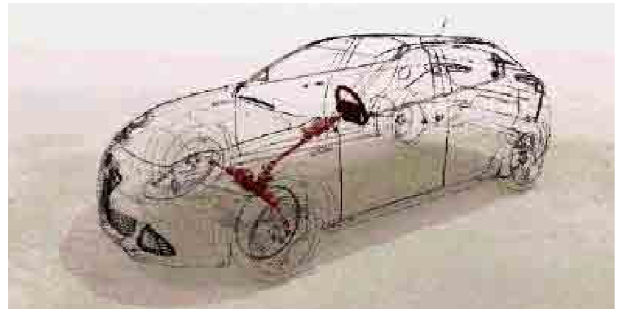
Dual Pinion actieve besturing.
